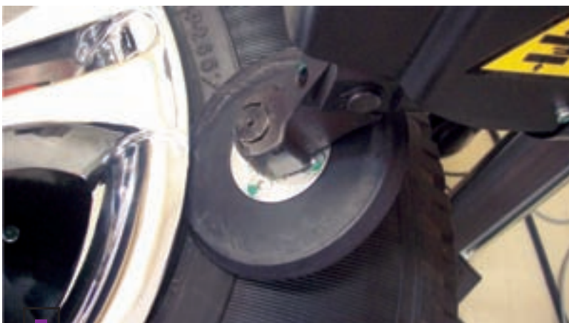
Отрыв борта с помощью роликового механизма
