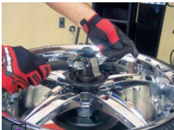
Крепление колеса фиксатором с пластиковым конусом
