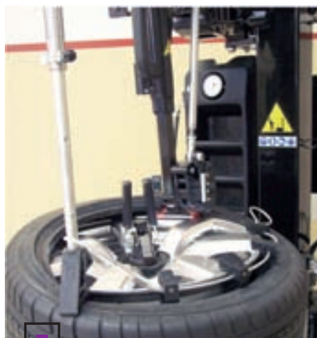
Сборка колеса с применением приспособлений для фиксации борта
