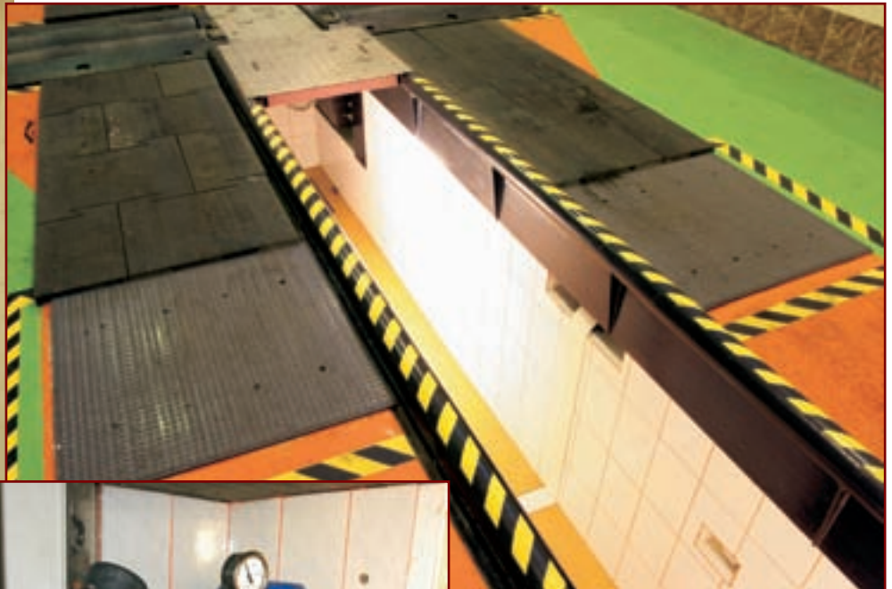
Гидравлический детектор зазоров позволяет определить люфты подвески.
