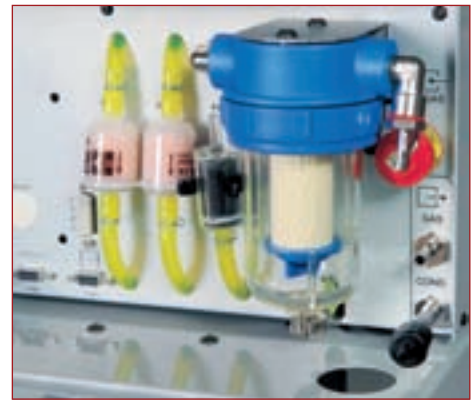
Обслуживание DGA 1500 сводится к периодической замене фильтров, расположенных с тыльной стороны корпуса.
