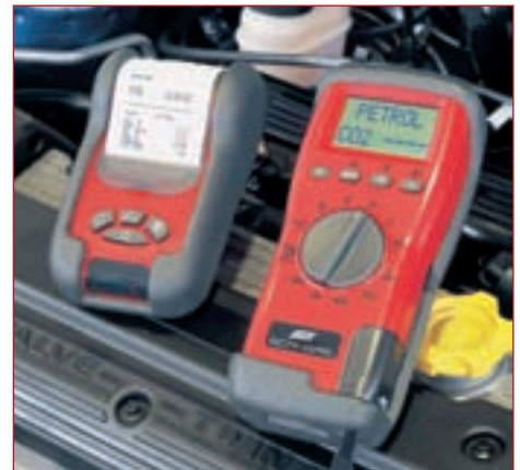
Небольшой ИК-принтер — полезное дополнение к газоанализатору «на ладони».
