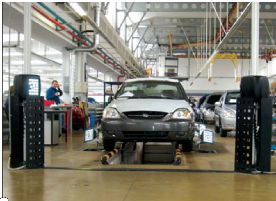
Отсутствие поперечной траверсы позволяет включить Visualiner 3D Arago в состав проездной диагностической линии.
