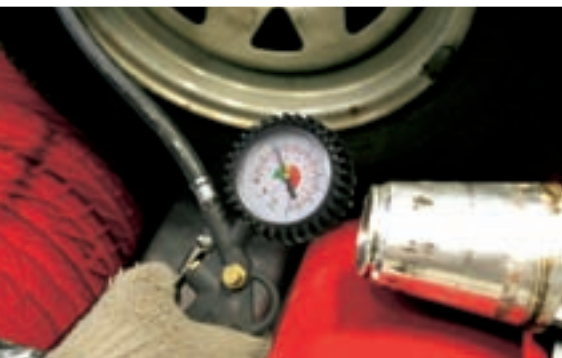
Проверка давления в шинах — необходимое условие для корректного ввода коэффициента трения качения колес.
