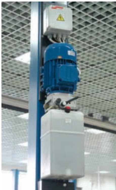
Гидростанция размещена в верхней части правой стойки.
