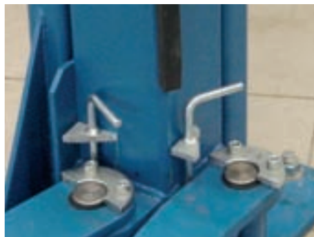
Механические фиксаторы блокируют подхваты, как только каретки поднимаются из нижнего положения.
