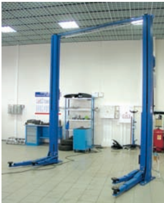
Короткий подхват имеет возможность поворачиваться на 180°, упрощая заезд на подъемник и выход из машины.
