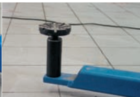
Подъемники имеют небольшую минимальную высоту подхвата (101 мм). Бесплатно прилагается комплект сменных проставок для увеличения высоты опорных подушек.
