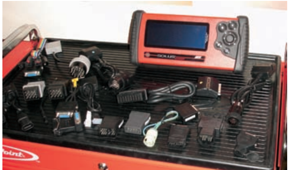
В комплект SOLUS входит полный набор кабелей-адаптеров для его соединения с диагностическими разъемами американских, европейских и азиатских автомобилей.
