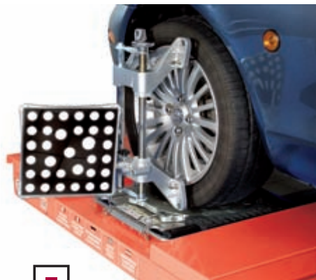
□ Легкие оптические мишени монтируются на передние колеса.
