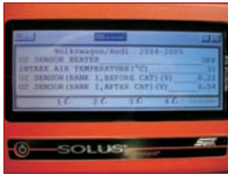
На экран могут выводиться параметры системы в текстовом виде.
