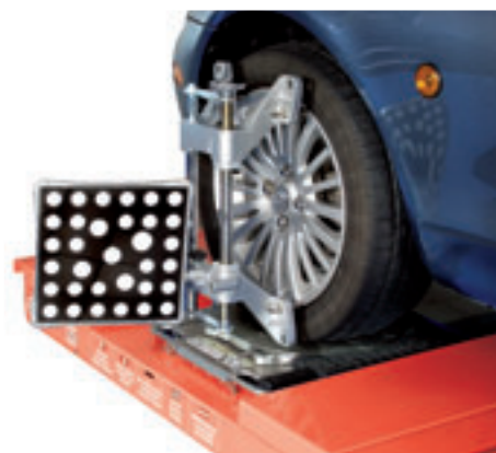
Легкие и «неубиваемые» оптические мишени монтируются на передние колеса с помощью держателей.
