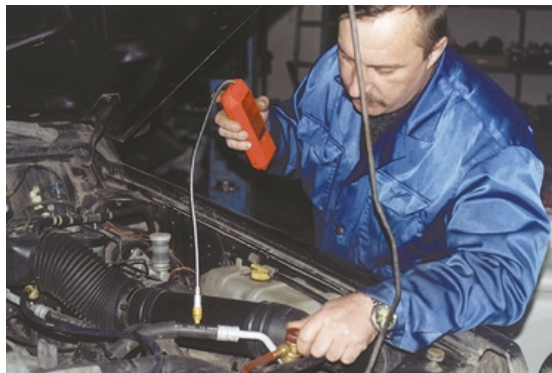
Течеискатель Sun безошибочно покажет место утечки фреона.
