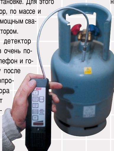
Современный течеискатель фирмы SUN . Несмотря на свой скромный вид, этот "малыш" незаменим при ремонте и заправке кондиционеров.
