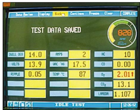
**В teste на холостом ходу обнаружилось, что система управления двигателем поддерживает слишком бедный состав топливной смеси (концентрация кислорода, показанная красным цветом, слишком велика).**
