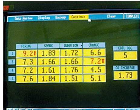
**Параметры системы зажигания, включая напряжение на различных элементах, не везде оказались в норме.**
